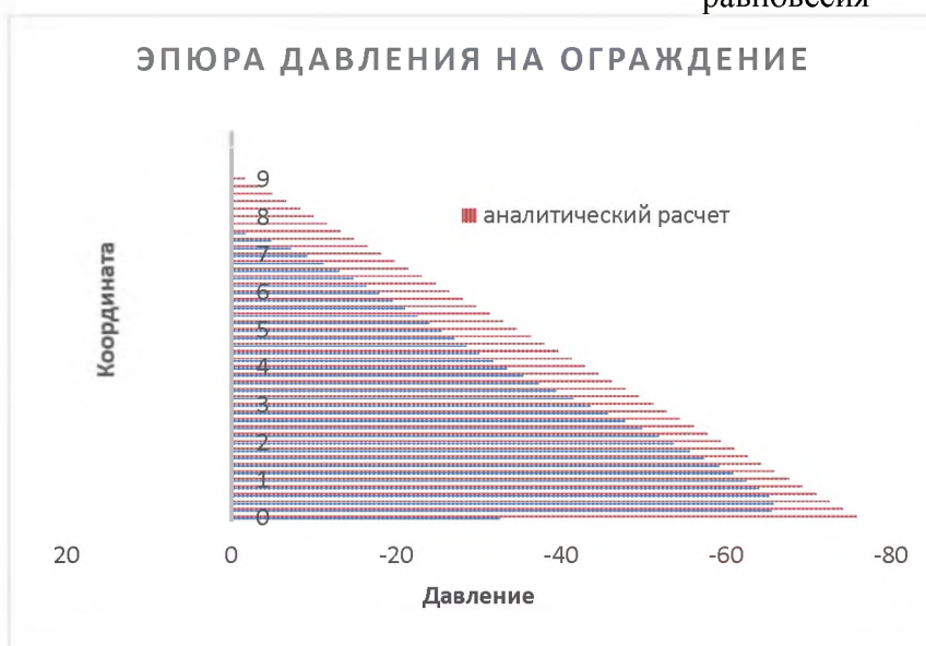
Рис. 5. Эпюры давления на ограждение
