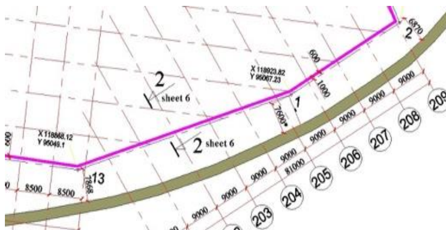
Рис. 1. Геотехническая расчетная ситуация: схема прохождения ТКК в зоне строящегося заглубленного сооружения
