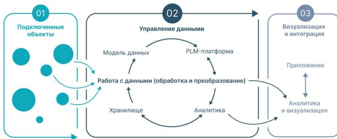
Рис. 1. Архитектура цифрового двойника (рисунок авторов)
