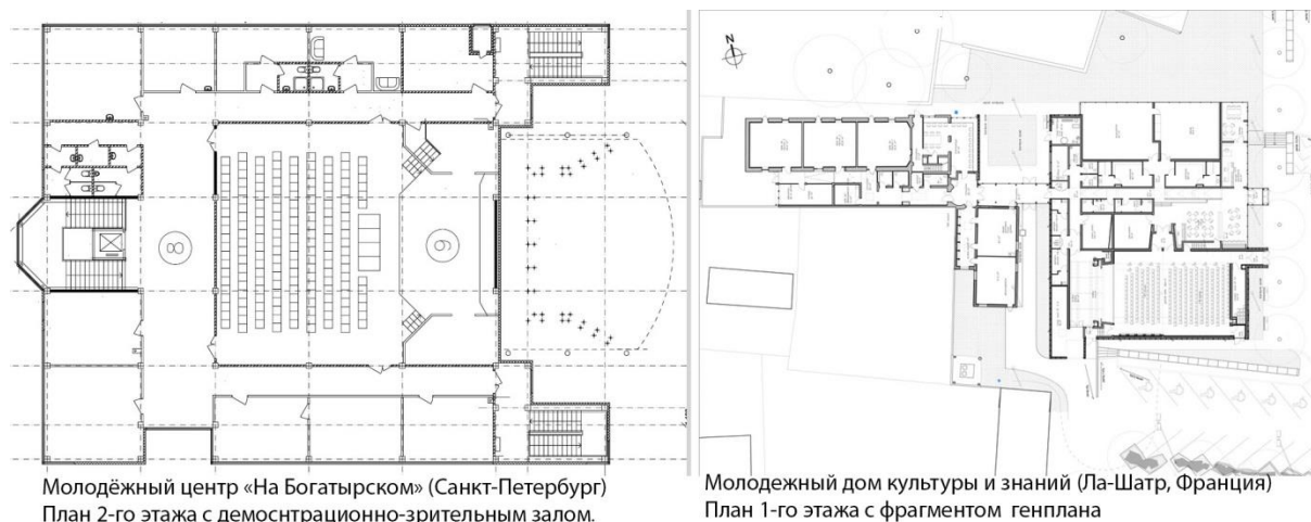
Рис. 2. Примеры размещения зрительного зала в планировочной структуре молодежного центра «На Богатырском» и молодежного дома культуры и знаний в Ла-Шатр (Источник: https://archi.ru/russia/70200/arkhitektura-dlya-molodozhi )
