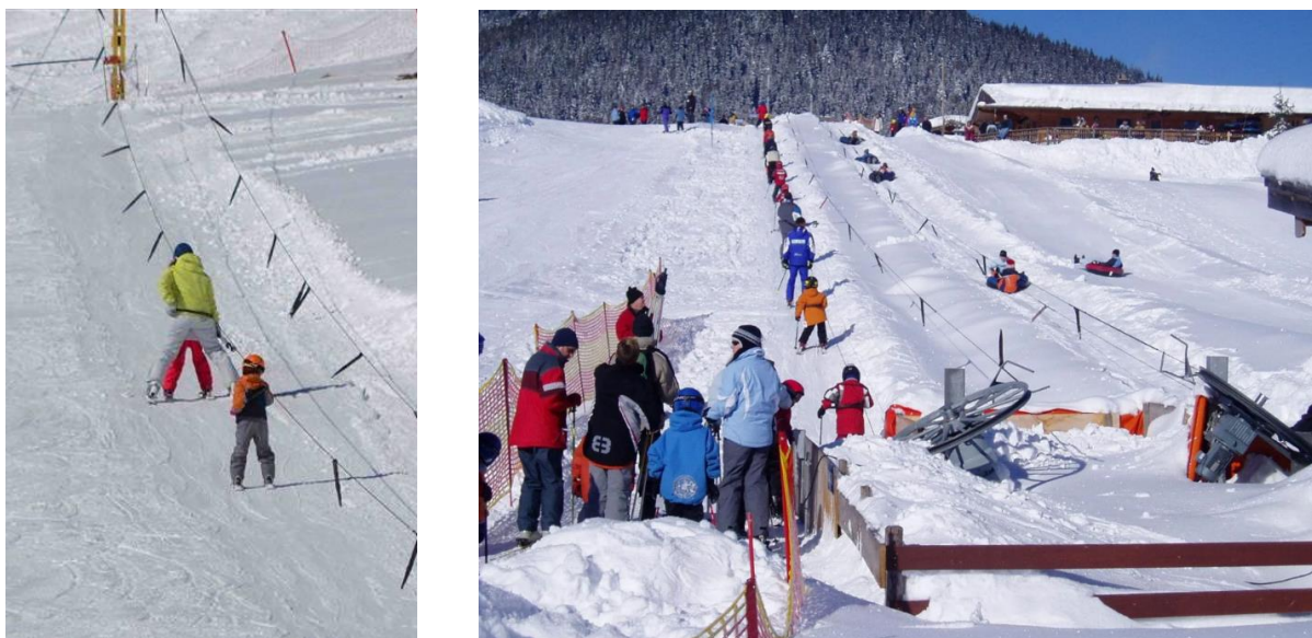
Рис. 17. Изображение безпорной канатной дороги [9]
