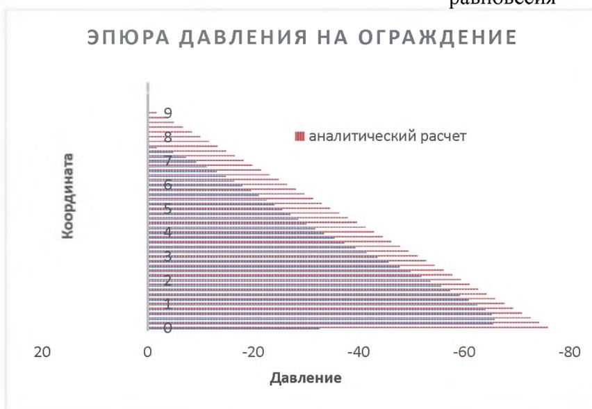
Рис. 5. Эпюры давления на ограждение
